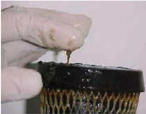
Figura-6. Biofilme grosseiro formado em filtro de carvão ativado.
