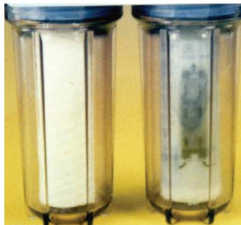
Figura-5. Filtros de carvão ativado sem biofilme (esquerda) e com biofilme evidente (direita).
