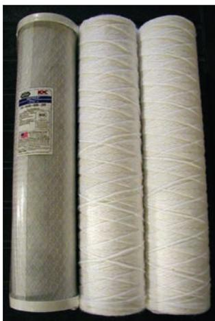
Figura-1. Filtros sem uso para purificação de água em laboratórios clínicos (da esquerda para a direita: filtro de carvão ativado, filtro pleissado 5 µm, filtro pleissado 1 µm).
