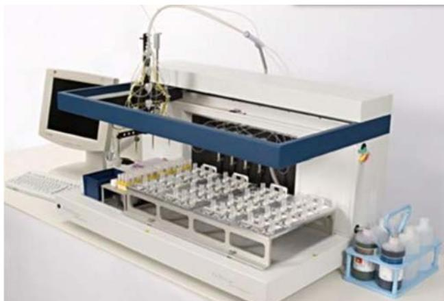
Figura 2. O PrepStain® transfere a amostra para a câmara de incubação montada nas lâminas, as células sedimentam por gravidade e é iniciado o processo de coloração automatizado.
